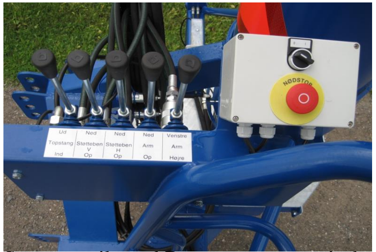
Steuerventile und Box zum automatischen Schwenken
