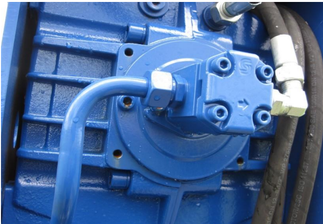
Ölpumpe und Kühler sorgen für die optimale Temperatur des Getriebes
