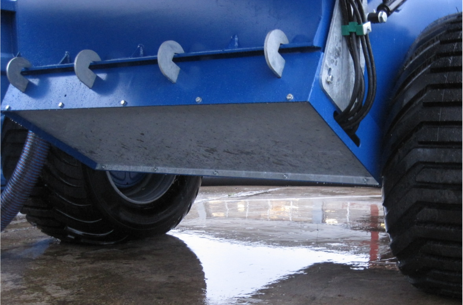
Sten tømmes let ud med den hydraulisk betjente låge.
