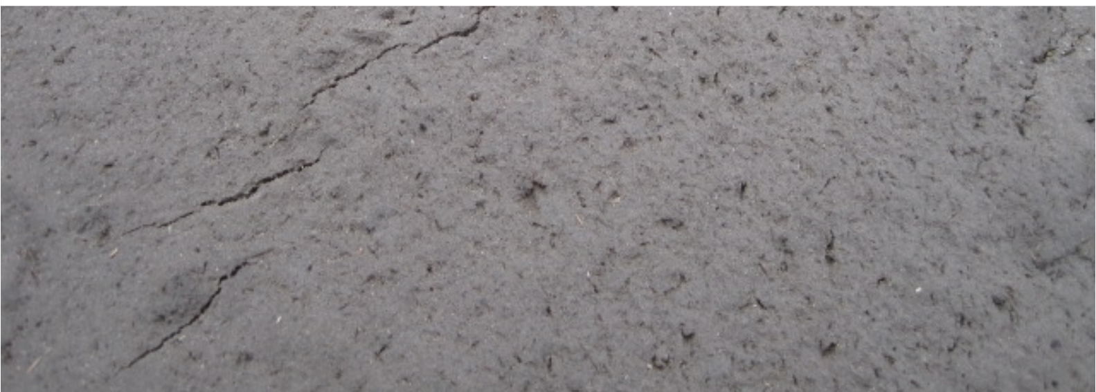
Bundfald fra buffertanken, partikler under 2mm, passeret buesien.
