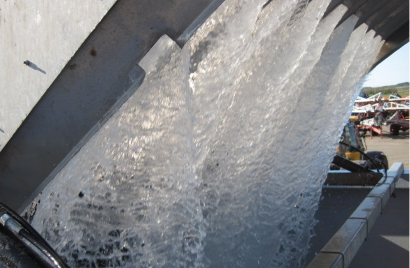
Buesi hvor partikler over 2mm bliver sorteret fra.
