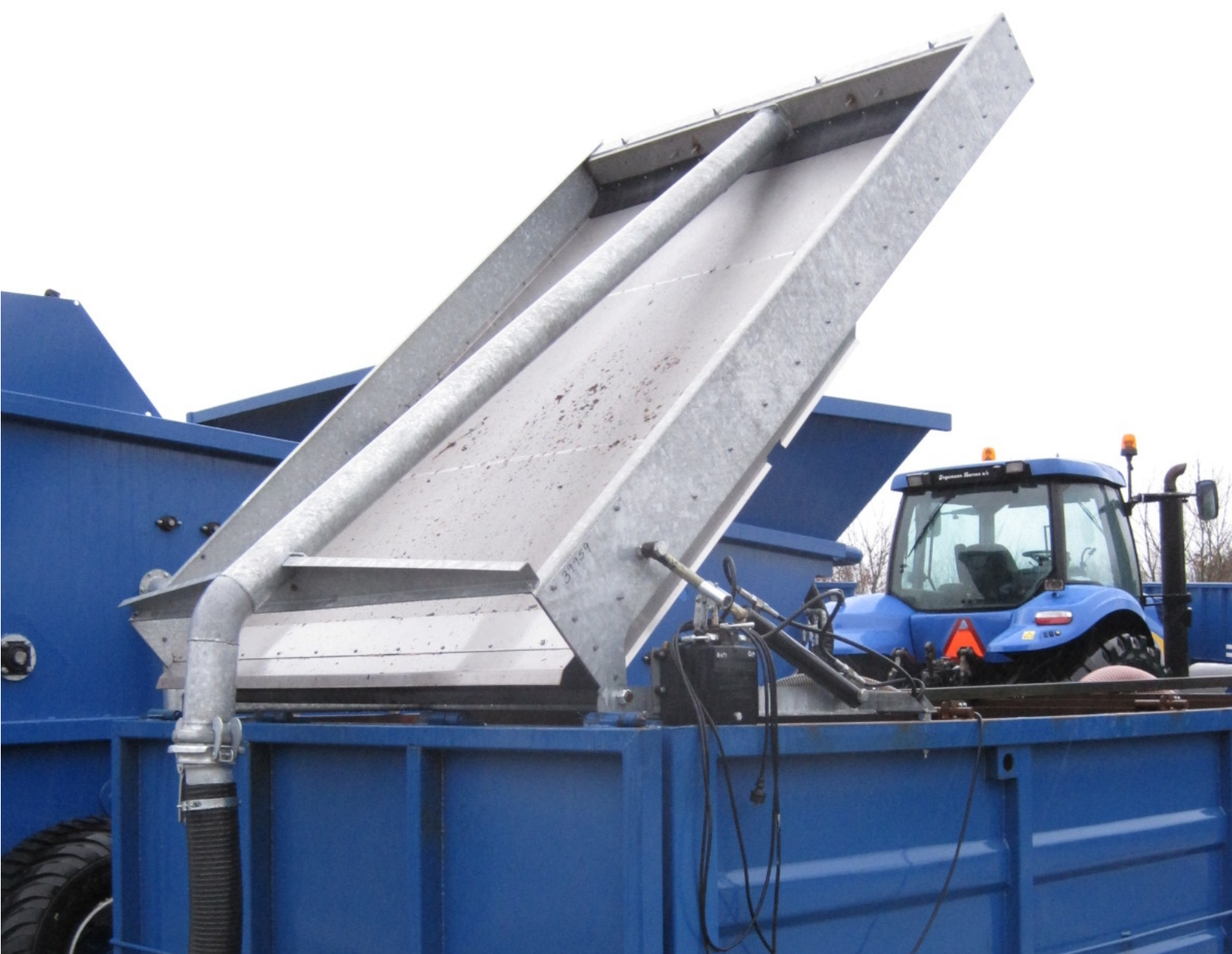
Buesi for afrensning ar partikler over 2mm.
