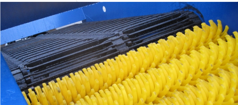
Tørrensning med 8 stk rensetromler og fødekæde
