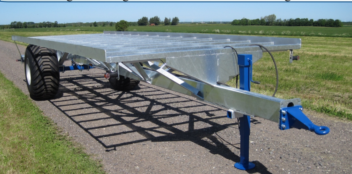
Stærk gitterkonstruktion - kraftig ladkant
