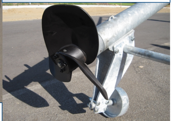
Kraftigt propel og stålhjul.
