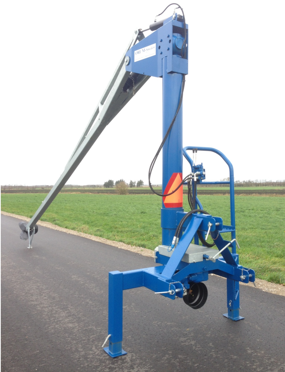
Den Effektive omrøring forbedres ved det fleksible drejetårn
