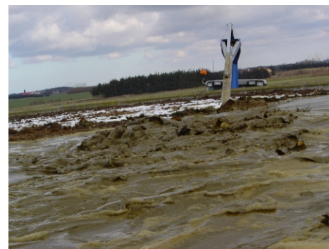
Den Effektive omrøring forbedres ved det fleksible drejetårn
